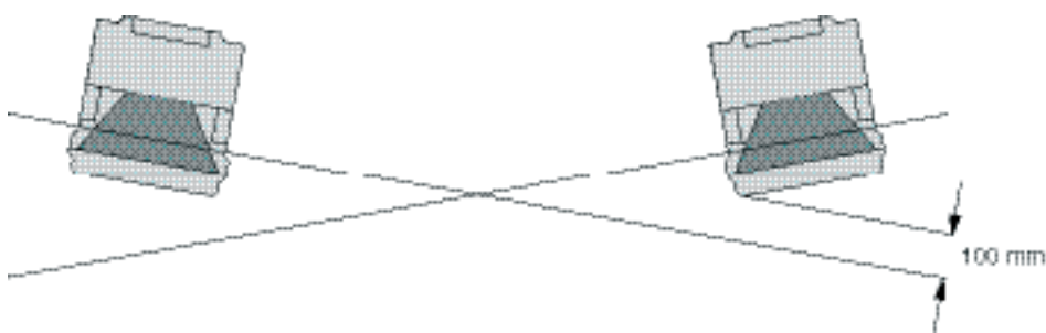
Ilustração 6.5: Montagem adjacente, sem desfasamento vertical, alinhamento cruzado
