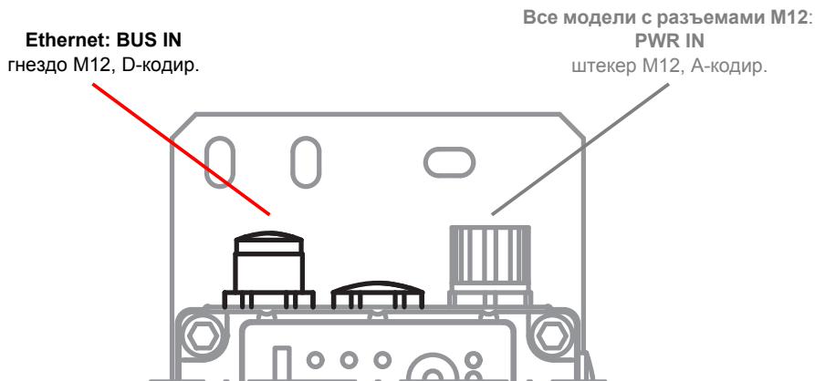
Рис. 10.2: Расположение и маркировка штекерных разъемов M12 сети Ethernet
