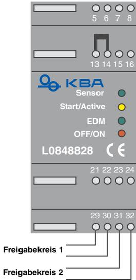
**Bild 4.2-7:** Verdrahtung Sicherheitsausgang (2-kanaliger Freigabekreis)
