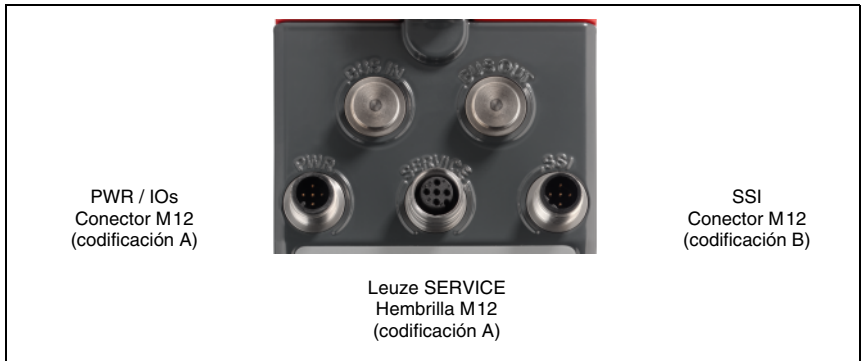
Figura 7.1: Conexiones del AMS 3007 i
