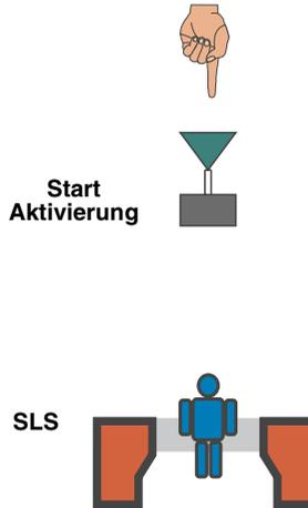
**Bild 5.5-4:** Anzeige des TNT 35/7-24V während einer Schutzfeldunterbrechung
