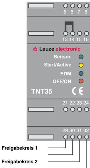
**Bild 4.2-7:** Verdrahtung Sicherheitsausgang (2-kanaliger Freigabekreis)
