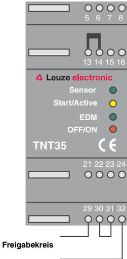
**Bild 4.2-6:** Verdrahtung Sicherheitsausgang (1-kanaliger Freigabekreis)
