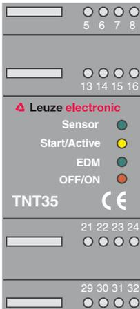
**Bild 4.1-2:** Anzeigeelemente am TNT 35
