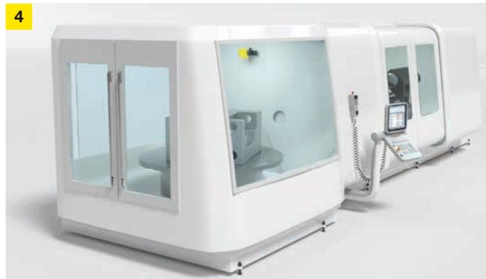
**Lösung:** Der im Bearbeitungsbereich platzierte Radarsensor erkennt Personen trotz rauer Umgebung zuverlässig. Meist kombiniert mit Sicherheits-Näherungssensoren an Maschinentüren und dem Sicherheitsschaltgerät wird ein Wiederanlauf verhindert, wenn der Überwachungsbereich nicht „frei“ und die Maschinen nicht „geschlossen“ ist.
