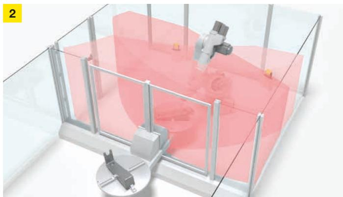
**Lösung:** Das 3D-Sicherheits-Radarsystem LBK überwacht die Anwesenheit von Personen im Schutzbereich und arbeitet auch unter rauen Umgebungsbedingungen zuverlässig. Die Radar-Technologie erlaubt zudem die Anwesenheit von statischen Objekten im überwachten Bereich.
