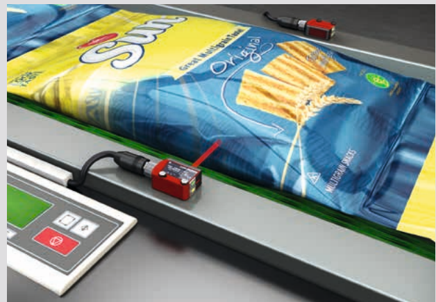
Inhaltskontrolle mit Foliendurchstrahlung
