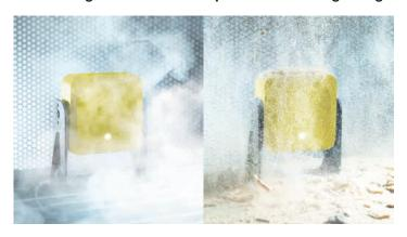
Das Radar-Prinzip ist robust gegenüber Umwelteinflüssen wie Schmutz, Staub, Sägespänen, Rauch, Öl, Feuchtigkeit und Licht. Damit werden auch bei anspruchsvollen Umgebungsbedingungen ein zuverlässiger Betrieb der Maschine gewährleistet und unnötige Abschaltungen vermieden.
