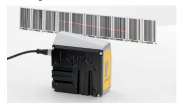
Das FBPS 600i arbeitet besonders zuverlässig. Mit jedem Scanvorgang werden mehrere Codes gelesen, aus denen die Software hochgenaue Positionswerte ermittelt. Durch den schrägen Verlauf des Scanstrahls und die Bewegung des Gerätes wird jeder Code an verschiedenen Stellen abgetastet. So werden Lesefehler durch lokale Verschmutzungen oder Beschädigungen vermieden.
