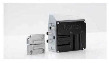
Das durchdachte Befestigungskonzept mit Schnellwechseleinrichtung ermöglicht eine einfache Montage der FBPS 600i. Mit nur einer, leicht zugänglichen Schraube an der Klemmhalterung werden die Geräte sicher befestigt. Dies spart Zeit bei der Montage, und im Servicefall lassen sich die Geräte schnell tauschen. Zudem sind die FBPS 600i durch den großen Lesedistanz-Bereich von 50 bis 170 mm einfach in die Anlage zu integrieren.
