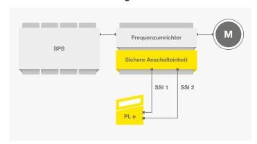
Mit dem FBPS 600i ist nur ein Sensor für die sichere Positionserfassung notwendig. Das Gerät wird über zwei SSI-Schnittstellen an eine sichere Auswerteeinheit – z.B. eines Frequenzumrichters – angeschlossen. Zudem erfüllen die Geräte bereits die Anforderungen für PL e / SIL 3. So lassen sich Sicherheitsfunktionen besonders einfach umsetzen und der Aufwand bei Installation und Service wird reduziert.
