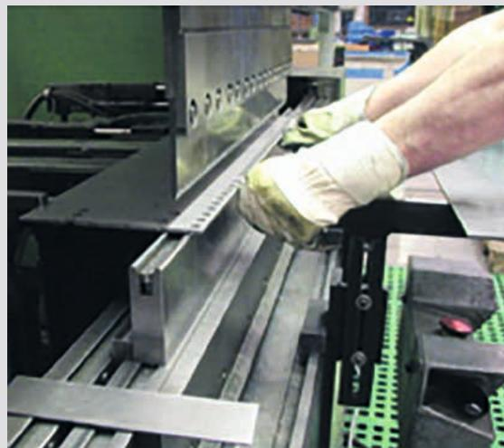
An einer Gesenkbiegepresse (ugs. Abkantpresse) besteht bei ungeschütztem Arbeiten die Gefahr des Abtrennens von mehreren Fingern beim Aufsetzen des Oberwerkzeugs auf das Werkstück. Ohne bzw. vor Schutzmaßnahmen kann sich dadurch folgende Einschätzung des Risikos mit HaRMONY ergeben:
