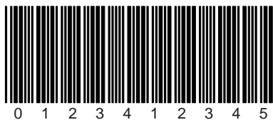
Figure 8.2 : Modèle du code à barres (Code 39 ; 0,35 mm ; rapport d'impression 2:1)
