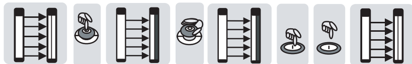
Fig. 4.2-4: Lo STOP d'emergenza di sezione condiziona la funzione "Blocco avvio/riavvio"
