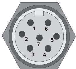
Fig. 7.4-2: Interfaccia verso la macchina del ricevitore/T3, connettore MIN-Series a 7 pin (vista sui pin)
