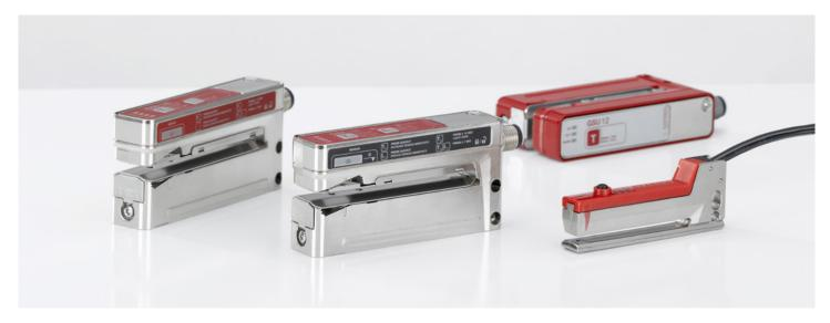
Il sensore a forcella GSX14E, della nostra nuova gamma di sensori a forcella, è il primo al mondo del suo genere a combinare in un unico alloggiamento entrambi i principi di rilevamento: quello ad ultrasuoni e quello ottico. Questo gli consente di unire i vantaggi di entrambi i principi e di riconoscere velocemente e in modo affidabile e preciso tutti i tipi di etichette, indipendentemente dai loro materiali e dalle loro caratteristiche.
