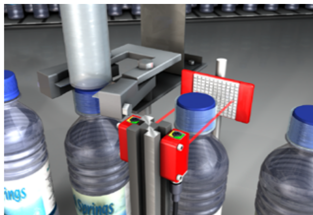
防拆封条检测
