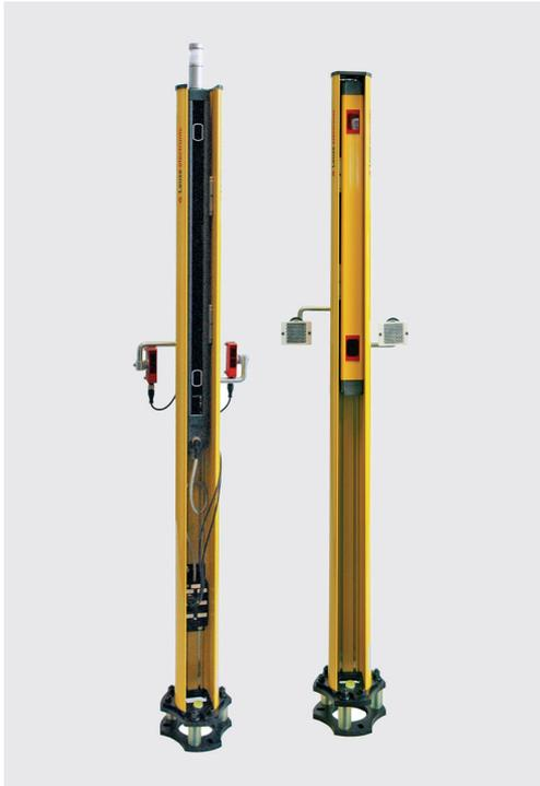
CPSET-M27 und -M28 sind Muting-Komplettsysteme für Zugangssicherungen, durch die betriebsbedingt Material transportiert werden muss. Neben der optischen Schutzeinrichtung mit integriertem LED-Mutingleucht-melder enthalten die CPSET zwei Gerätesäulen, in denen die Geräte so vormontiert werden, dass sie einfach in der Höhen verstellbar sind. Muting wird durch zwei unabhängige Signale gesteuert, die gleichzeitig innerhalb von 3,5 s aktiviert werden müssen:
