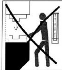
**Abbildung 4-3** Gefahr durch Hintertreten des Schutzfeldes. Durch Anwendung eines DIALOG in gewinkelter Version abzusichern
