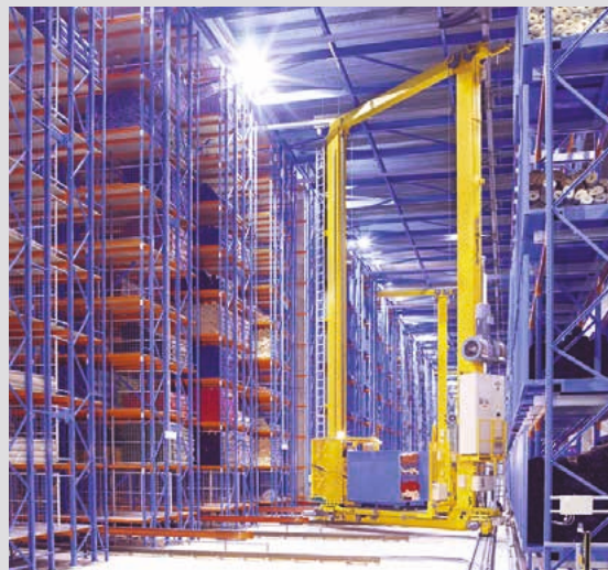
Sichere Schleichgangsgeschwindigkeit bei manuellem Betrieb der Achsen, z. B. EN 528 mit 0,05 m/s
