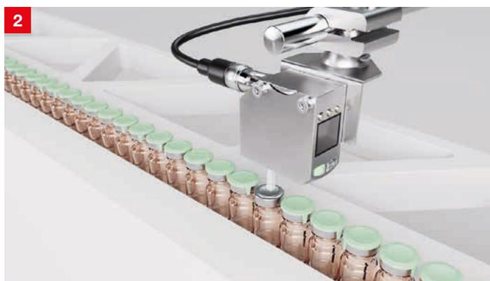
**Lösung:** Die Farbsensoren CRT 648 mit Glanzunterdrückung erkennen die hochglänzenden Verschlusskappen der Vials prozessstabil. Die Bedienung und Einstellung der Sensoren erfolgt dank des großen LC-Displays einfach und schnell.
