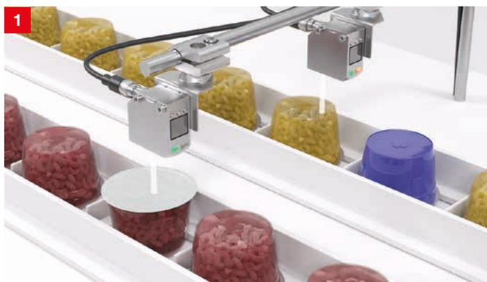
**Lösung:** Die neuen Farbsensoren CRT 648 können mit bis zu sieben Farben eingelernt werden. Sie sind mit einem großen Lichtfleck ausgestattet und erkennen zuverlässig die Farben der Verpackungen sowie des Deckels. Die große Tastweite bis 150 mm sorgt für eine zuverlässige Erkennung, auch beim Wechsel zu anderen Formaten.
