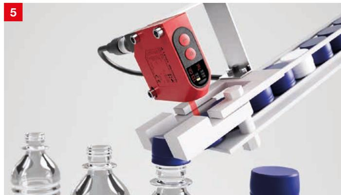
**Lösung:** Die geteachte Farbe des Deckels wird vom CRT 448 erkannt und per Ausgangssignal des Sensors mit Sortiervorrichtung entsprechend falsche Deckel aussortiert.
