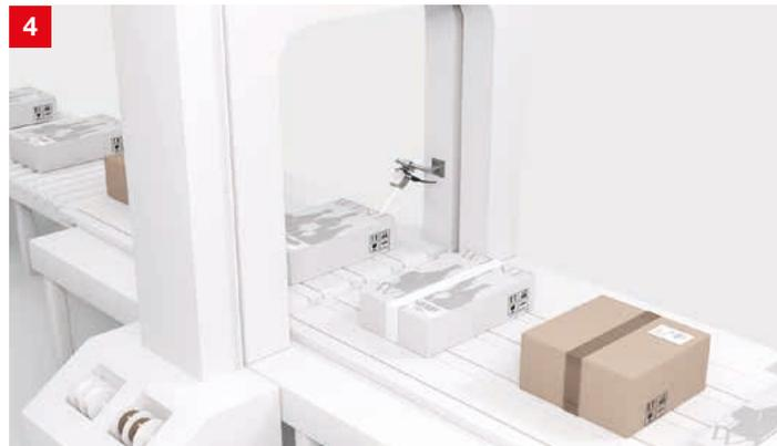
**Lösung:** Farbsensoren der Serie CRT 648 erfassen die Farbe des Kartons und melden die Information an den Umreifer weiter. So kann die Anlage die passende Bandfarbe wählen.
