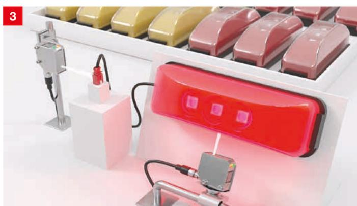
**Lösung:** Im ersten Prozessschritt prüft ein Farbsensor CRT 648 die Farbe des Steckers. Ein weiterer CRT 648 überprüft daraufhin, ob das Rücklicht die richtige Lichtfarbe sowie Intensität aufweist.
