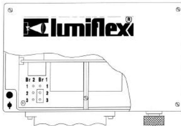
Abbildung 2-4 Brücke Br1 im Inneren des BASIS
