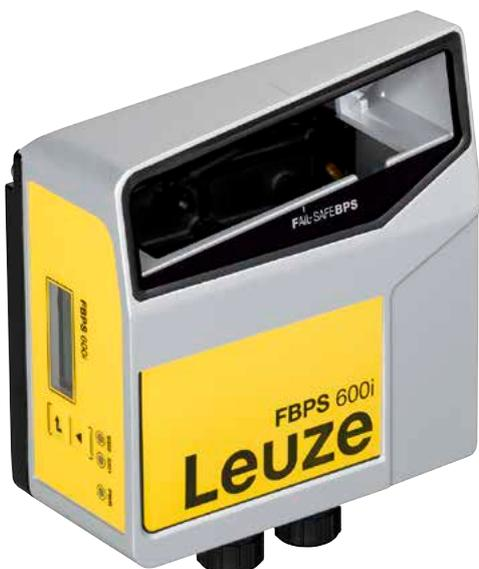
Mit dem weltweit ersten Sicherheits-Barcode-Positioniersystem FBPS 600i ist nur noch ein Sensor für die sichere Positionserfassung notwendig. Das Gerät wird über zwei SSI-Schnittstellen an eine sichere Auswerteeinheit – z. B. eines Frequenzumrichters – angeschlossen und ist für Anwendungen bis Performance Level e geeignet. So lassen sich Sicherheitsfunktionen besonders einfach umsetzen und der Aufwand bei Installation und Service wird reduziert.
