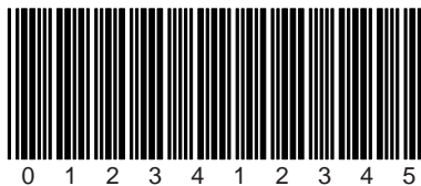
Bild 8.2: Barcode-Muster (Code 39; 0,35 mm; Druckverhältnis 2:1)
