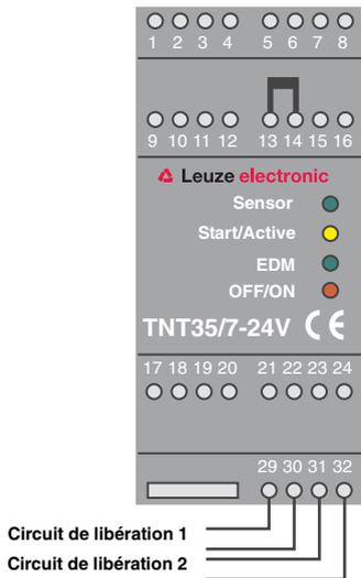
**Figure 5.2-7:** Câblage de la sortie de sécurité (circuit de libération à deux voies)
