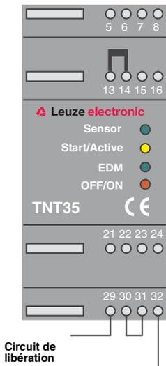
**Figure 4.2-6:** Câblage de la sortie de sécurité (circuit de libération à voie unique)
