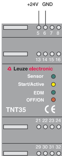
**Figure 4.2-1:** Câblage de l'alimentation
