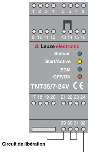
Figure 5.2-6: Câblage de la sortie de sécurité (circuit de libération à voie unique)
