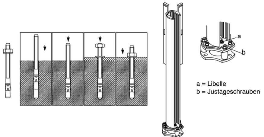
1. Die Geräte sind bereits in der UDC Gerätesäule montiert. Die Montagehöhe in der Säule kann durch Lösen der Inbus-Schrauben der Klemmhalterungen angepasst werden.
