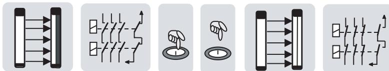
**Abb. 4.2-3:** Schützkontroll-Funktion, im Beispiel kombiniert mit A-/WA-Sperre
