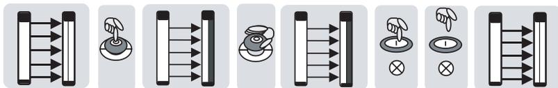
**Abb. 4.2-5:** Bereichs-NOT-AUS bedingt die Anlauf-/Wiederanlaufsperr Funktion
