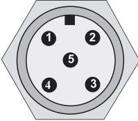
**Abb. 7.8-3:** Empfänger Maschinen-Interface /A1, Gerätestecker M12 5-polig (Blick auf die Stifte)
