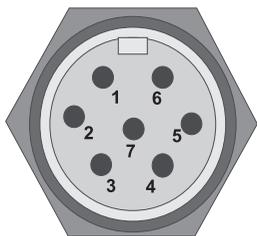
**Abb. 7.4-2:** Stecker MIN-Series 7-polig – Sicht auf die Stifte des Gerätesteckers des Empfänger Maschinen-Interface
