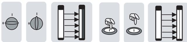
**Abb. 4.2-1:** Anlauf-/Wiederanlaufsperr-Funktion beim Einschalten der Versorgungsspannung
