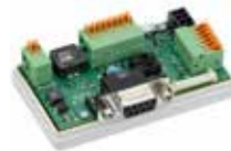
MA-CR 어댑터 서킷 보드 연구실 또는 테스트 시 적합 적용 제품: CR 100, BCL 95, DCR 50, DCR 55
