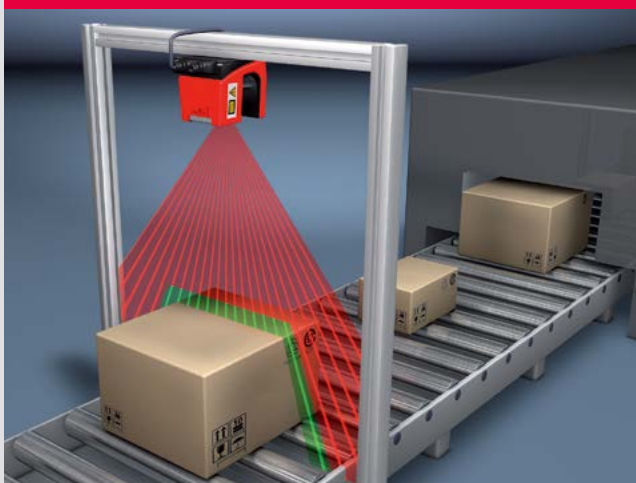
物体位置和高度检测，用于防碰撞保护
