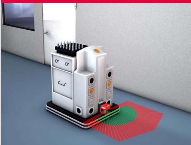
无人驾驶运输系统的防碰撞保护
