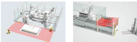
Sicherheits-Lösungen, z. B. zur Sicherung von Übergabestationen
