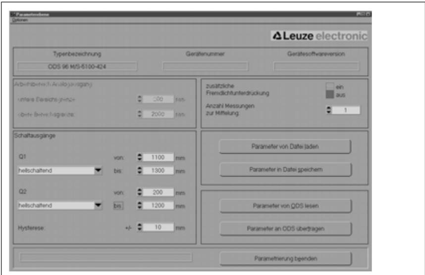
Bild 10.8: Beispiel Parametrierebene: ODS 96 ohne Analogausgang mit 2 Schaltausgängen
