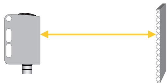
**Apprendimento per una sensibilità del sensore dell'11% (bottiglie altamente trasparenti e pellicole di spessore > 20µm)**
