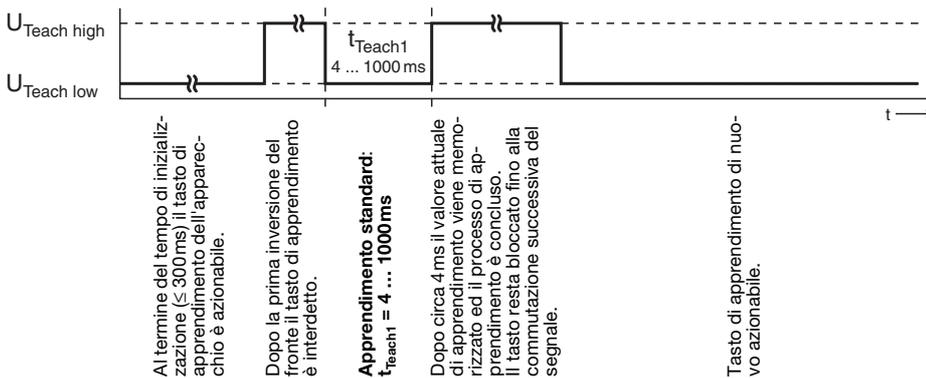
**Apprendimento rapido per una sensibilità del sensore dell'11% (bottiglie altamente trasparenti e pellicole di spessore > 20µm)**
