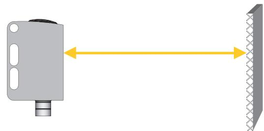
**Teach para sensibilidad del sensor del 11% (botellas muy transparentes y láminas con espesor > 20µm)**
