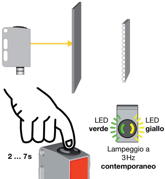
**Regolazione del comportamento dell'uscita di commutazione - commutazione per presenza o assenza di luce**
