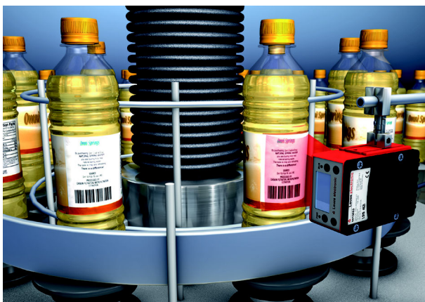
Figura 3.6: Esempio di applicazione posizione etichetta ed identificazione etichetta
