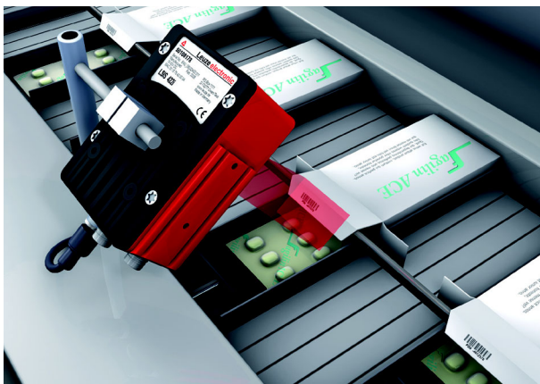
Figura 3.4: Esempio di applicazione verifica codice
