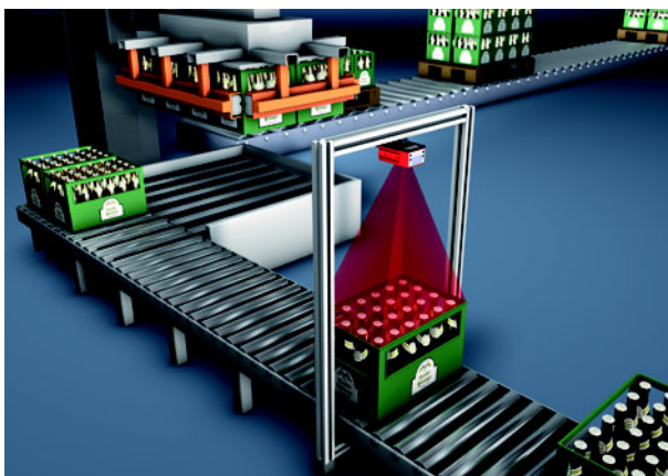
Figura 3.2: Esempio di applicazione: controllo della completezza
