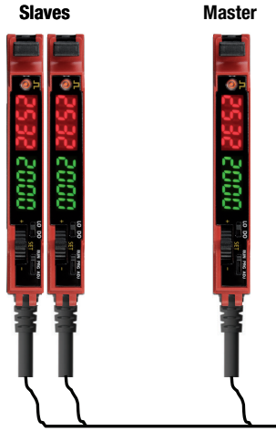
Alle Multifunktionseingänge multi funct (Pin 2/ws-WH) sind parallel geschaltet
