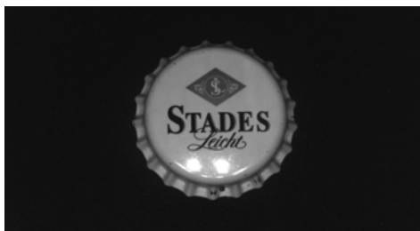
Bild 4.13: Schräge Kameraausrichtung, alle 4 Beleuchtungsquadranten aktiv – besser, aber noch Reflexionen eines Quadranten sichtbar
