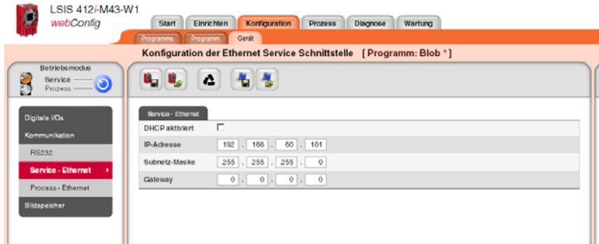
Bild 3.22: Modul "Konfiguration", Register "Gerät" – Kommunikation "Service - Ethernet"
