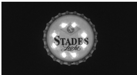
Bild 4.12: Senkrechte Kameraausrichtung – maximale Reflexionen
