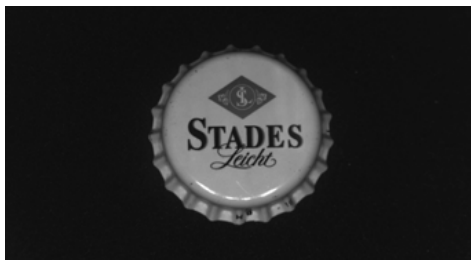
Bild 4.14: Schräge Kameraausrichtung, nur 3 Beleuchtungsquadranten aktiv (reflektierter Quadrant ist aus) – fast alle Reflexionen im Bild unterdrückt
