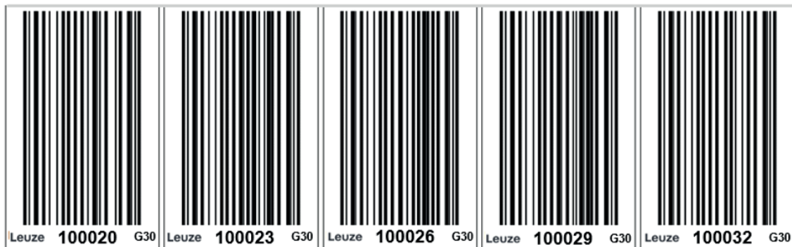
Bild 9.1: Barcodeband G30, beginnend mit Positionswert 1000,20 m im Verlauf um 3 cm / 30 mm aufsteigend Unterbrechungsfrei aneinandergereiht ergeben die Barcodes ein digitalisiertes Maßband im 30 mm-Raster. Das BCB wird entlang der Messstrecke (Fahrstrecke) geklebt.
