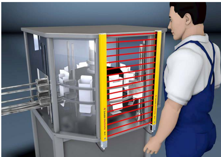
Fig. 5.1: Resgarde as proteções de acesso a pontos de perigo ao intervir na zona de perigo, por exemplo, no caso de uma máquina de cartonagem e sistemas de enchimento
