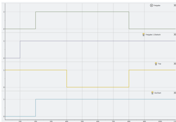
Bild 7.108: Minimalistischer Ablauf Baustein Presse Einrichten
