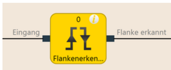
Bild 7.24: Logische Anschlüsse für den Funktionsblock Flankenerkennung
