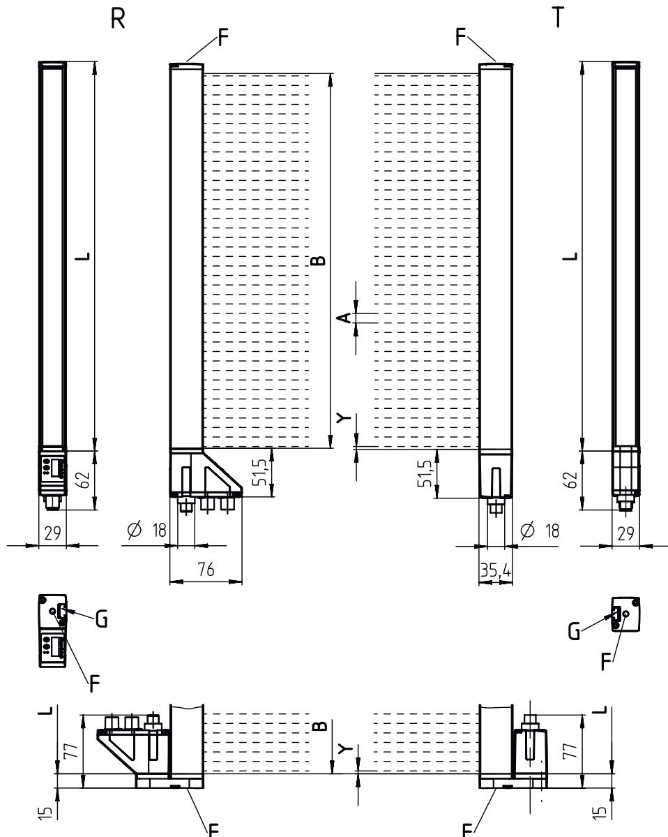
A Intervalle entre les faisceaux 5 mm
