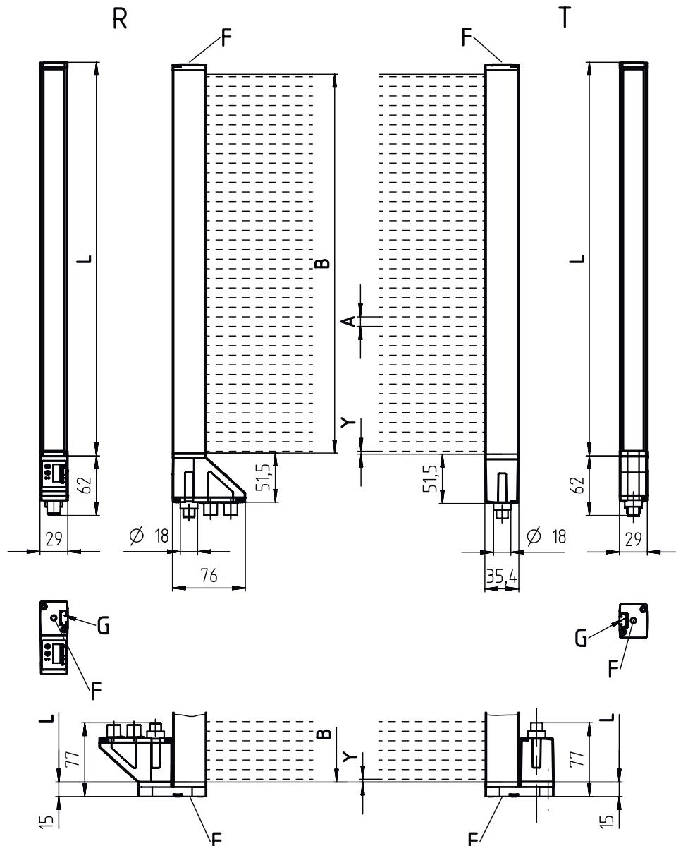
A Intervalle entre les faisceaux 5 mm
