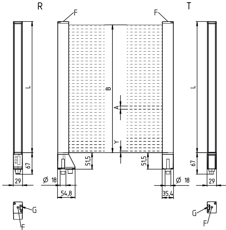
A Intervalle entre les faisceaux 20 mm
