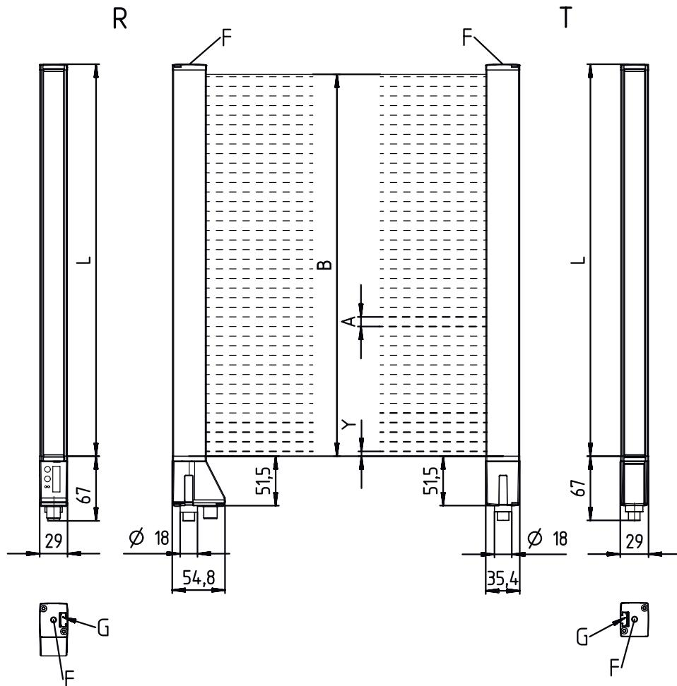
A Intervalle entre les faisceaux 5 mm
