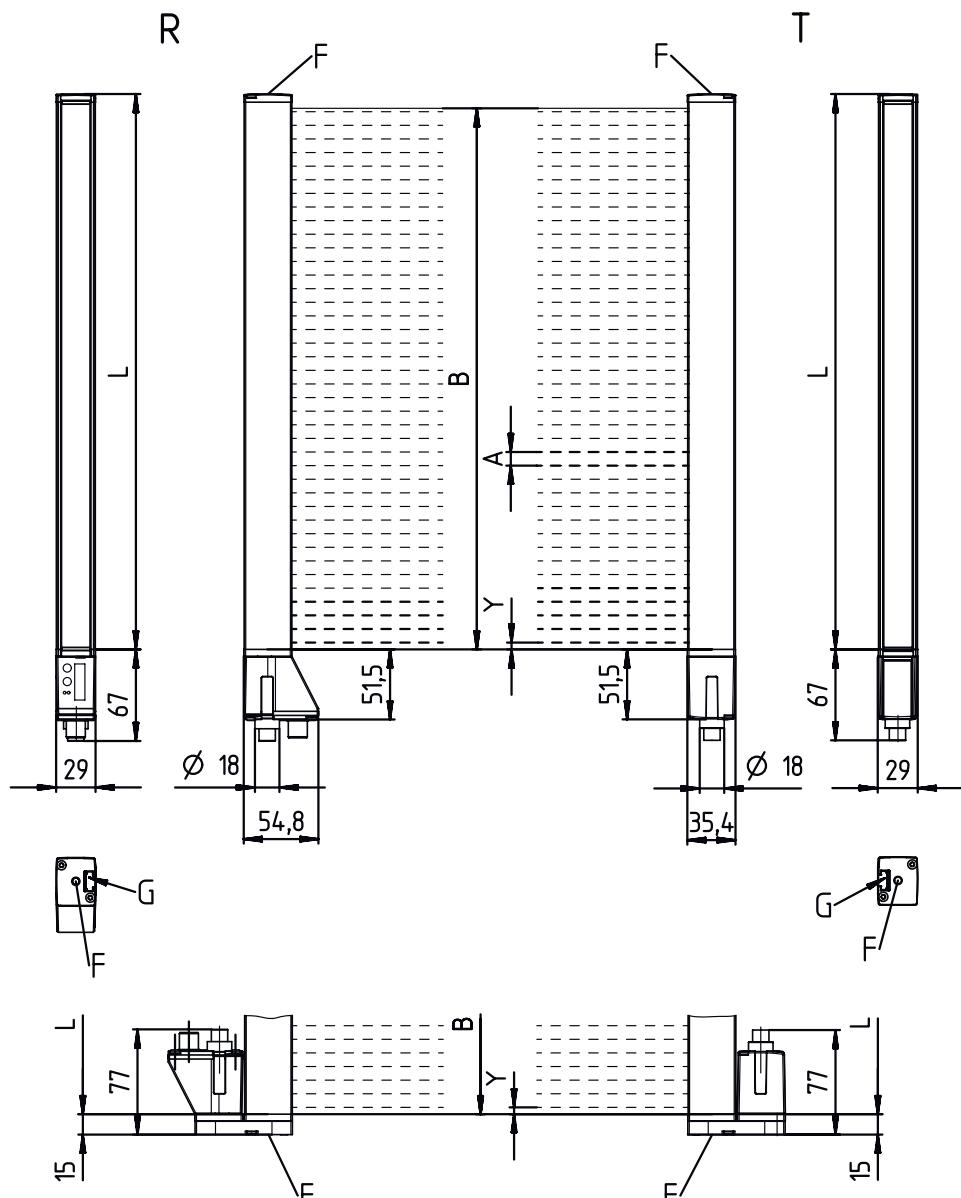
A Intervalle entre les faisceaux 5 mm
