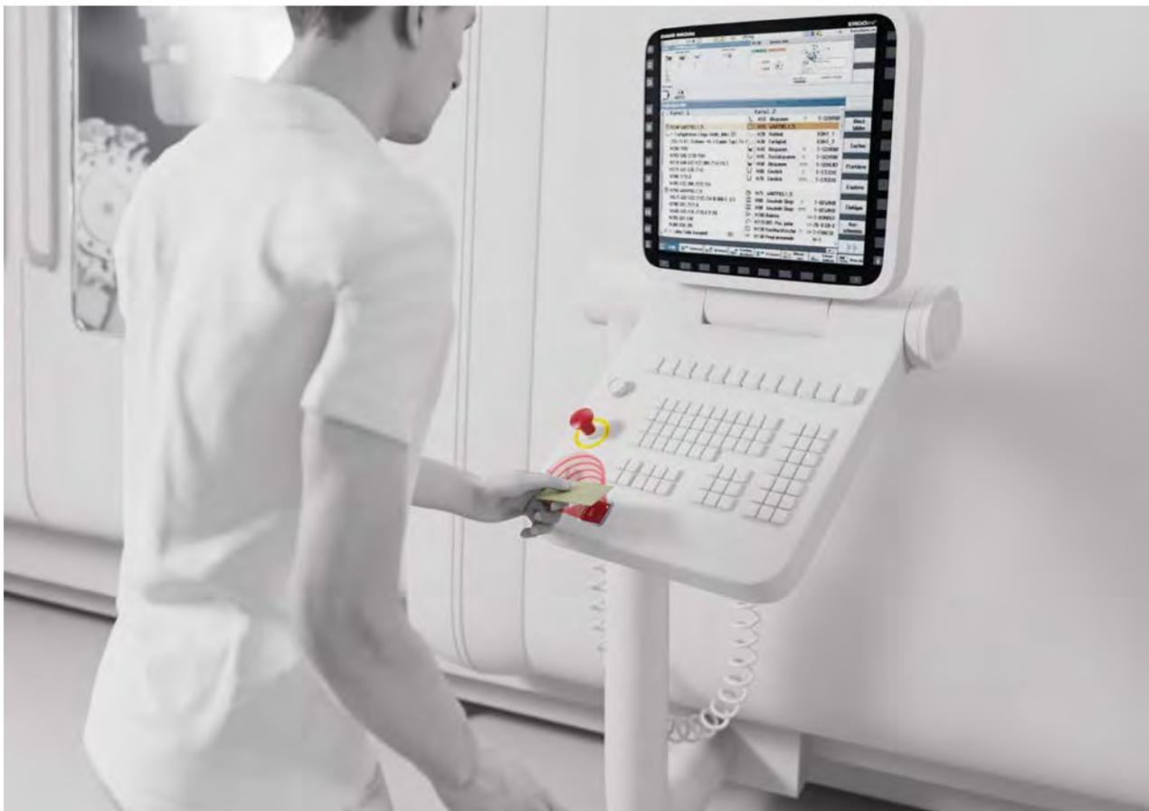
Fig. 5.4: Authentification des utilisateurs sur les machines
