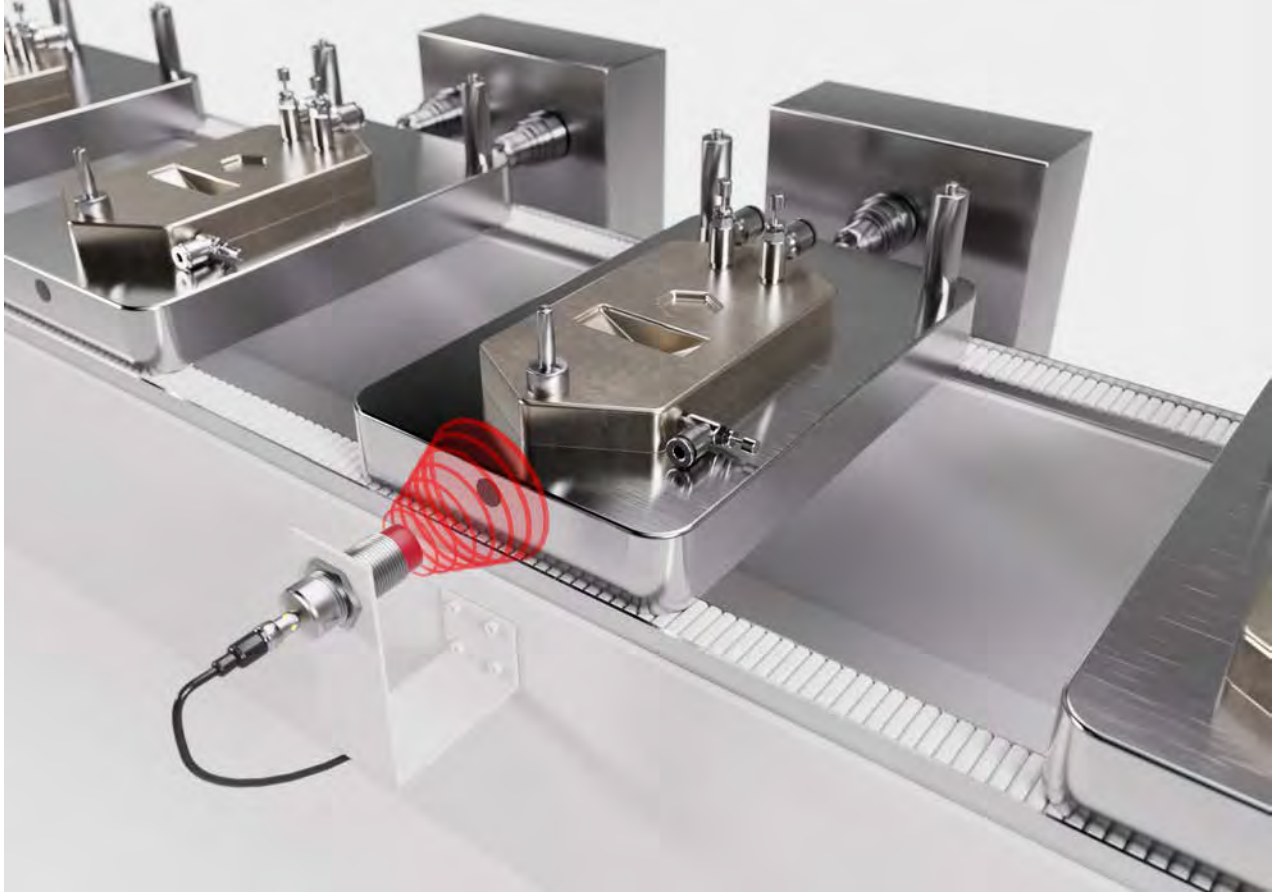
Resim 5.2: İş parçası taşıyıcılarının üretim kontrolü
