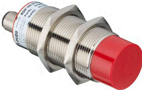
De manière générale, l'appareil RFID RDH 142 est conçu pour des applications dans le domaine de la maintenance et du contrôle de la production avec des portées allant jusqu'à 6 cm. La configuration de l'appareil s'effectue au moyen de l'IODD ou du serveur web d'un maître IO-Link et permet l'adaptation à une multitude de tâches de lecture. La distance de lecture accessible dépend des conditions environnementales individuelles et des types de transpondeurs utilisés.
