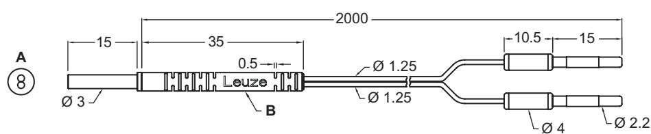
A Ø 0,5 mm noyau de la fibre de verre x 2 pièces
