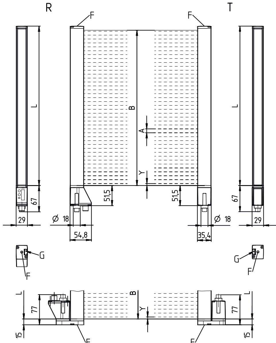
A Intervalle entre les faisceaux 5 mm
