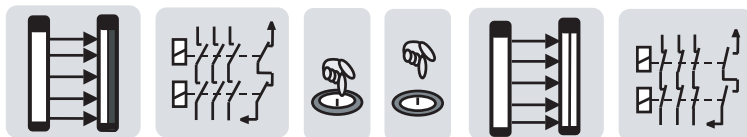
Fig. 4.2-3: Funzione controllo contattori, combinata in questo esempio con la funzione RES
