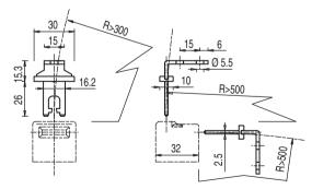
Figure 13.2: AC-AH-A actuator
