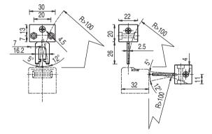
Figure 13.4: AC-AH-F2J2 actuator
