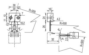
Figure 13.3: AC-AH-F4 actuator
