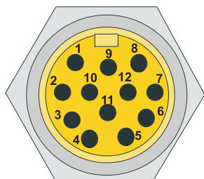
Fig. 7.8-1: Interfaccia del ricevitore verso la macchina/R3, connettore MIN-Series (vista sui pin)
